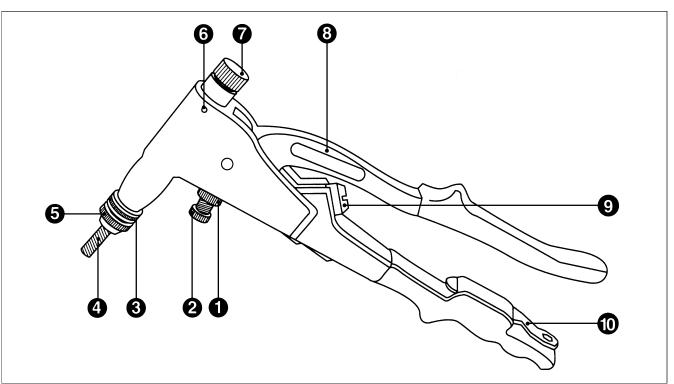
Pour régler la course du tirant, visser ou dévisser la vis de butée (2) suivant le réglage désiré.
