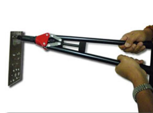
**4** - Ouvrir les 2 leviers. Tourner la mollette (A) jusqu'à ce que le tirant se détache de l'écrou.
