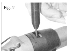
Ce réglage est nécessaire pour assurer une déformation optimale de l'écrou. Si la course est trop importante, la déformation de l'écrou sera trop importante (possibilité que l'écrou reste bloqué sur le tirant, ou que le tirant casse). Alors que si la course est trop courte, la déformation de l'écrou sera insuffisante et l'écrou ne sera pas fixé correctement.
